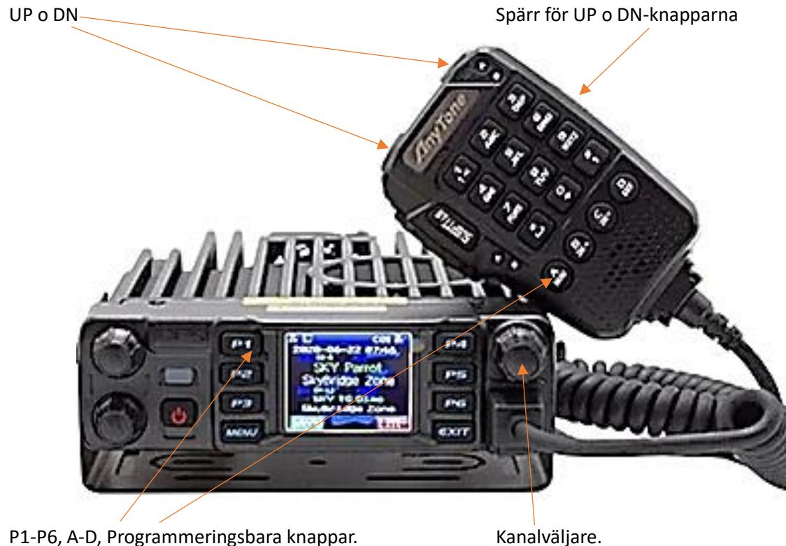
TBST (1750) : Tryck PTT + DN eller UP (Spärr för DN och UP måste tas bort med skjutknapp på höger sida av mikrofonen, skjut knappen uppåt)
